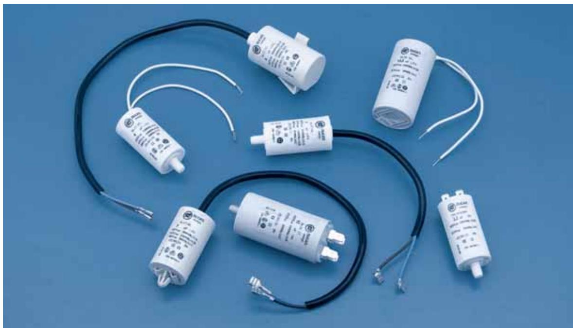
Il dielettrico è in film di polipropilene, le armature sono costituite da un sottilissimo deposito metallico ottenuto per evaporazione sotto vuoto.
